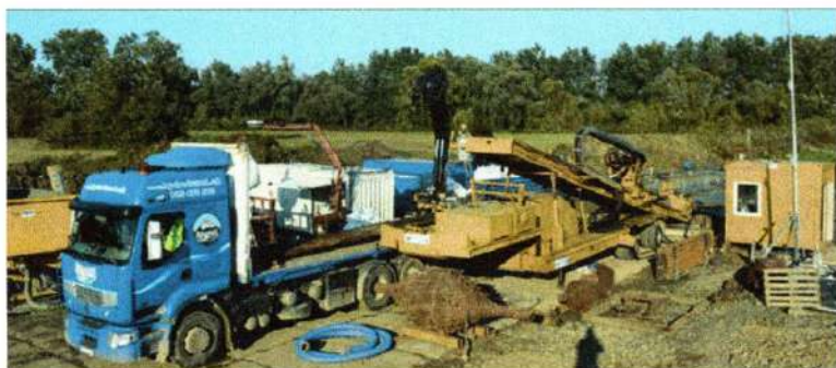
Foto 4 Vrtací stroj HDD s ťažnou silou 1200 kN (120 ton)
