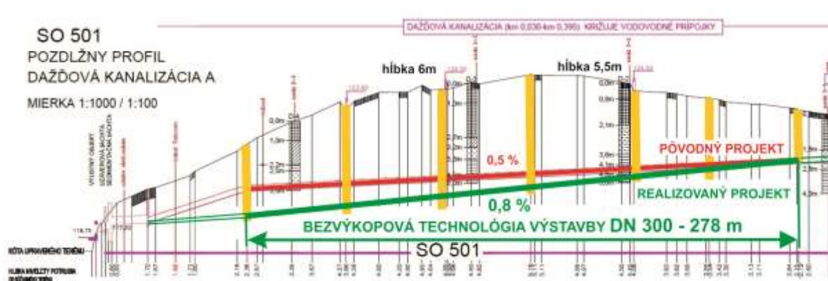
Obr.1. Pozdĺžny profil - 278 m dlhý úsek kanalizácie DN 300 referenčnej stavby v Dvoroch nad Žitavou pri Nových Zámkoch so šachtami v strede kopca v hĺbkach až 6m.
